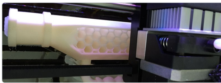
Modell zum Anfassen – 3D-Druck aus dem Anlagenmodell für Abstimmungen
